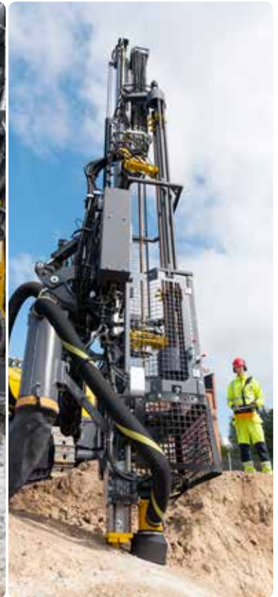
ガードの下部はゴム製になっており、様々な位置での掘削に柔軟に対応します。FlexiROC T35 Rに装備された保護ガード。
