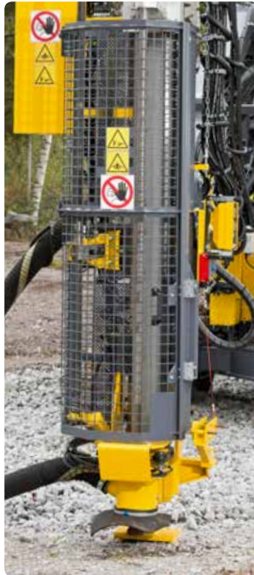
保護ガードは、ドリルロッドが回転しているブームからオペレーターを守ります。写真はFlexiROC T30 Rに取り付けられた保護ガード。
