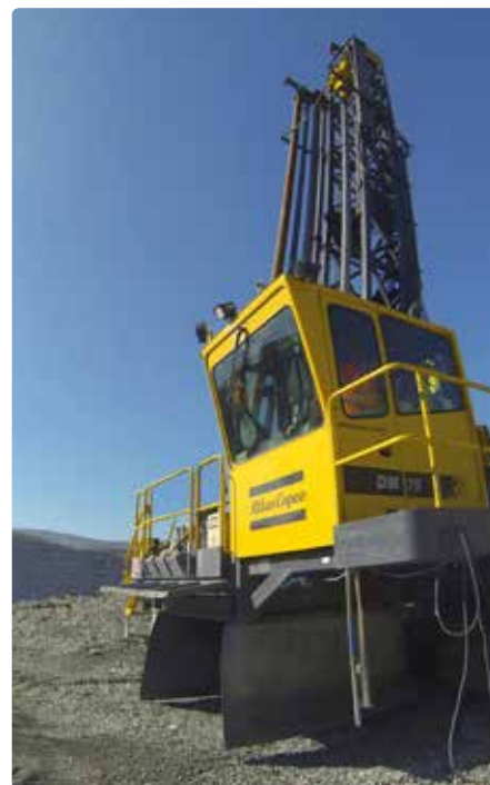
DM 75: 大孔径硬岩せん孔用の高性能ロータリードリル
