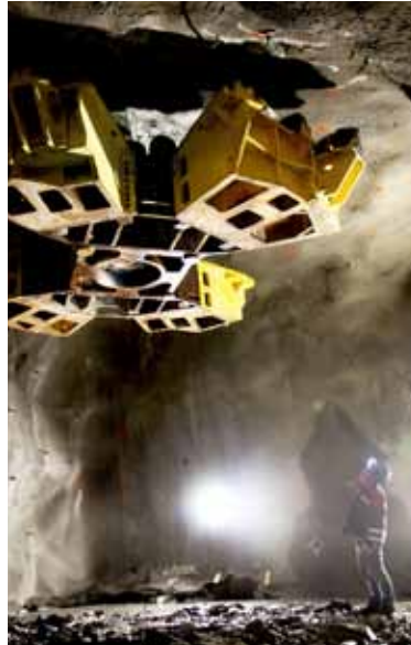
¡Arriba! La gigantesca cabeza de corte del Robbins 91RH escariando hacia arriba el pozo piloto.
