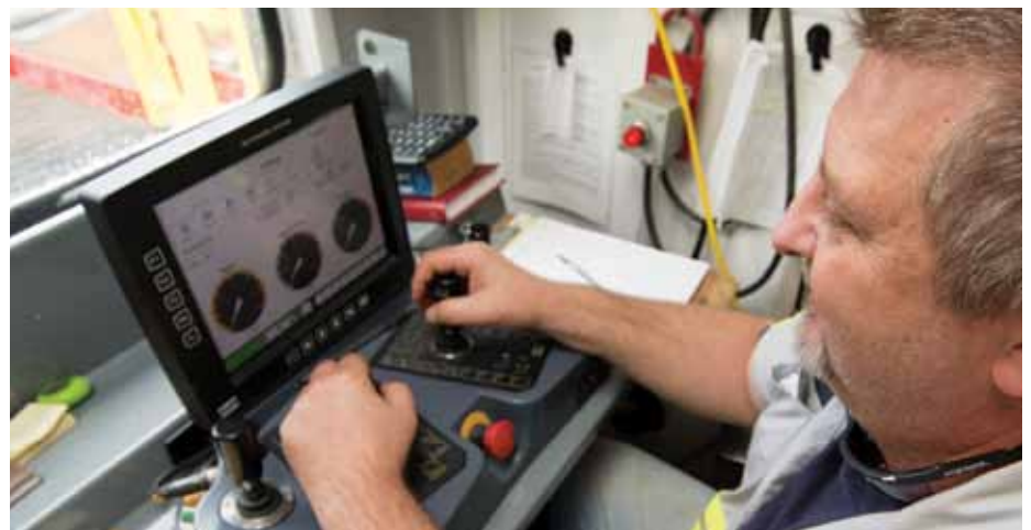
James Bass de Robbins opera la perforadora de chimeneas Robbins123RH C desde la tranquila comodidad de su estación de operación remota.
