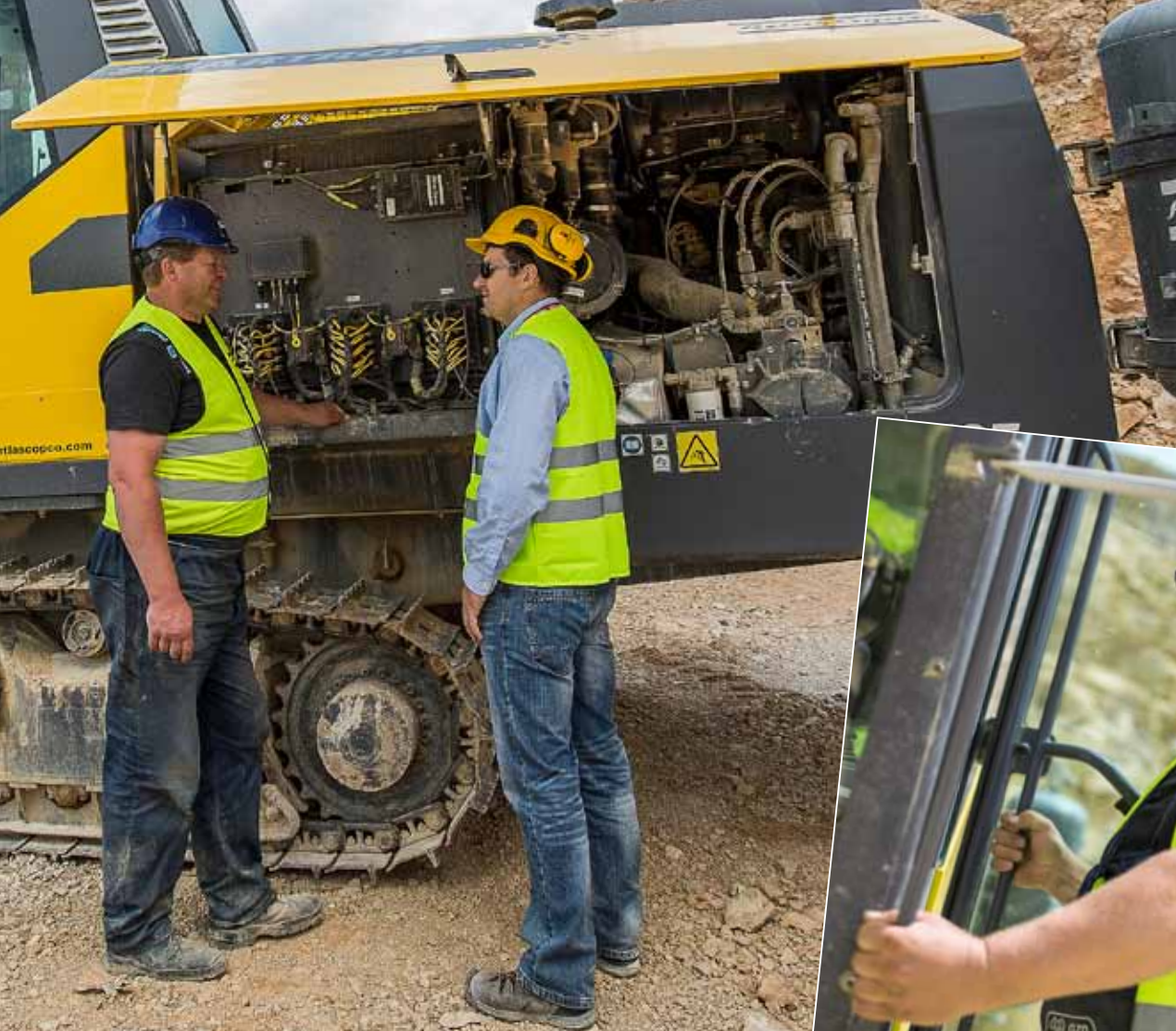
Respondiendo al desafío: El SmartROC T35 fue entregado a la cantera GZD Siewierz Con un kit silenciador y un sistema recolector de polvo. (Arriba, a la derecha,) Marcin Płachta, Manager de producto en Atlas Copco, discute los beneficios con el operador Marek Borówka.
