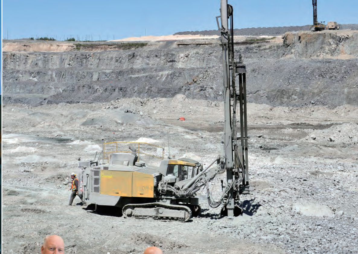
最強のコンビ: SmartROC D65ダウンザホールドリルリグ(前面)と遠方でのPit Viper 271ロータリー発破ドリルリグ(右上)
