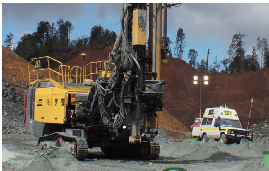
不安定なベンチ作業での強い味方アトラスコプコSmartROC D65とBenchREMOTEを搭載した車(右)。タスマニア州のサベジリバー鉱山にて。
