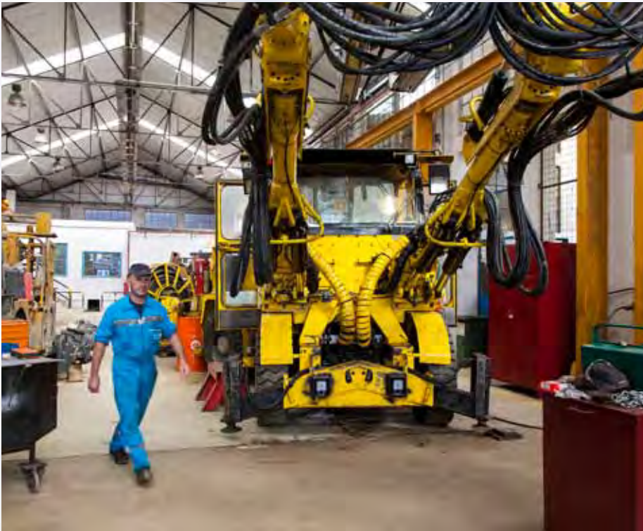
Parte de la flota: El Atlas Copco Boomer 128, usado en la construcción de los caminos de acceso a la rampa principal, durante el servicio y mantenimiento en el taller de Aljustrel.
