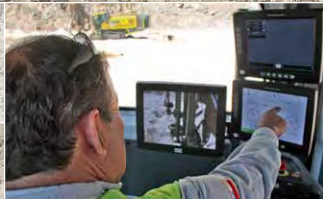
Los tiempos están cambiando: A la izquierda, el SmartROC D65 perforando en forma autónoma, mientras que el operador (derecha) controla todas las funciones desde una distancia segura.
