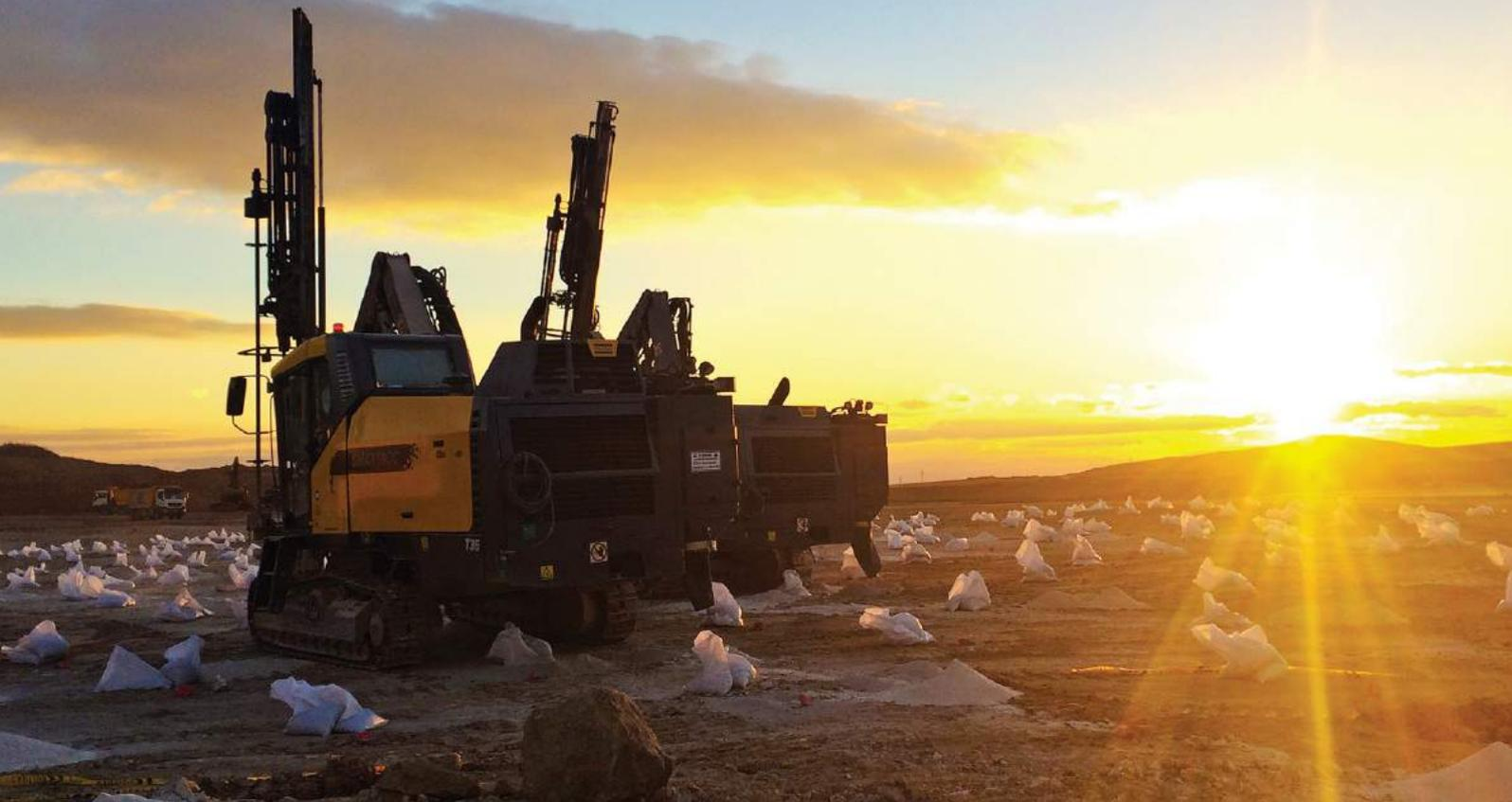
*Для испытания коронок Powerbit были выбраны станки Atlas Copco SmartROC T35 и FlexiROC T35. Они бурили взрывные скважины глубиной 5,5 м. Каждый станок оснащался 102-мм короной Powerbit T51 с юбкой Retrac и сферическим вооружением HD (справа).*
