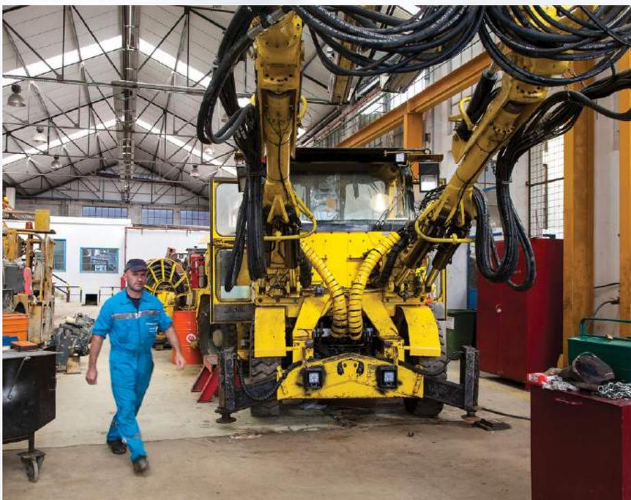
Часть парка оборудования: мастерская на руднике Алжустрел, сервис и техническое обслуживание бурового станка Atlas Copco Boomer 128, используемого в строительстве подъездных выработок от главного уклона.
