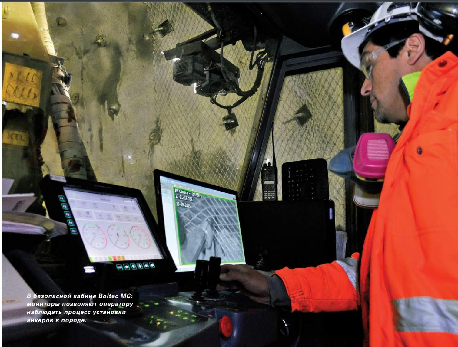
*В безопасной кабине Voltec MC: мониторы позволяют оператору наблюдать процесс установки анкеров в породе.*
