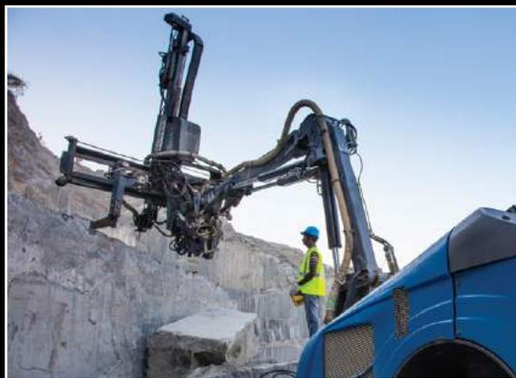
**ROCK BUGGY** — небольшой, компактный 4-колесный станок для перфораторного бурения вертикальных скважин. Полный привод и все управляемые колеса обеспечивают высокую мобильность и эксплуатационную гибкость. Задний мост с независимой подвеской позволяет станку легко маневрировать на пересеченной местности. Станок оснащен направляющими длиной до 3 м для быстрого наведения на скважину, а также противозаклинивающей системой для точного бурения прямолинейных и параллельных скважин.
