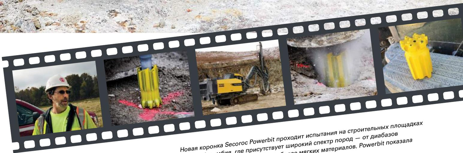
Новая коронка Secoroc Powerbit проходит испытания на строительных площадках округа Колумбия, где присутствует широкий спектр пород — от диабазов твердостью 275 МПа до намного более мягких материалов. Powerbit показала блестящие результаты.
