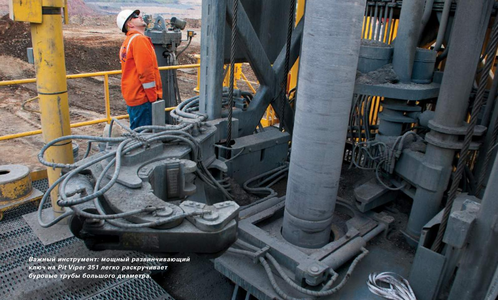
*Важный инструмент: мощный развинчивающий ключ на Pit Viper 351 легко раскручивает буровые трубы большого диаметра.*
