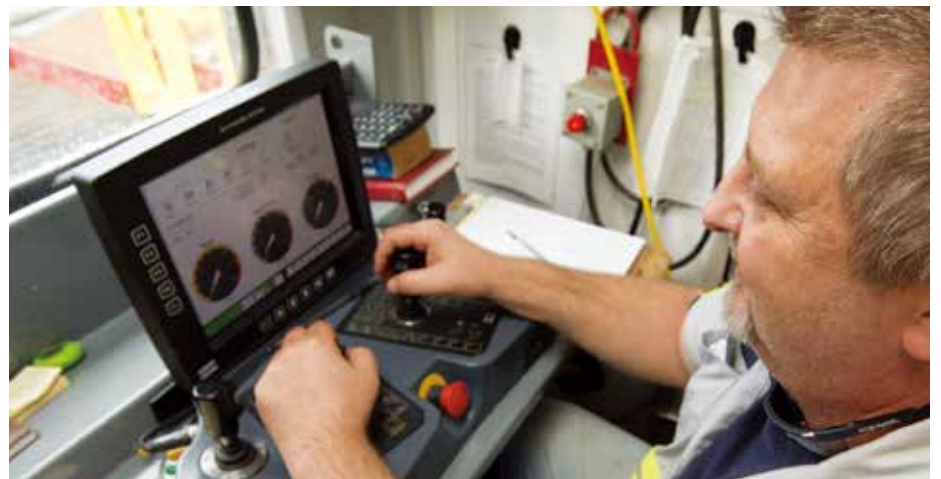
静かで快適なリモートオペレーションセンターから、Robbins 123RH C レイズボーリング機を操作する、レイズボーのジェームスバースさん。
