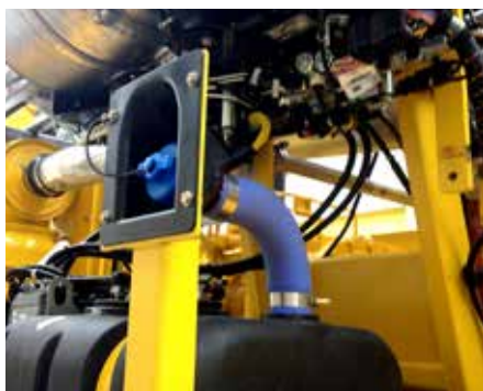
Pit Viperに取り付けられた、一目瞭然の青いリフィルキャップとホース。
