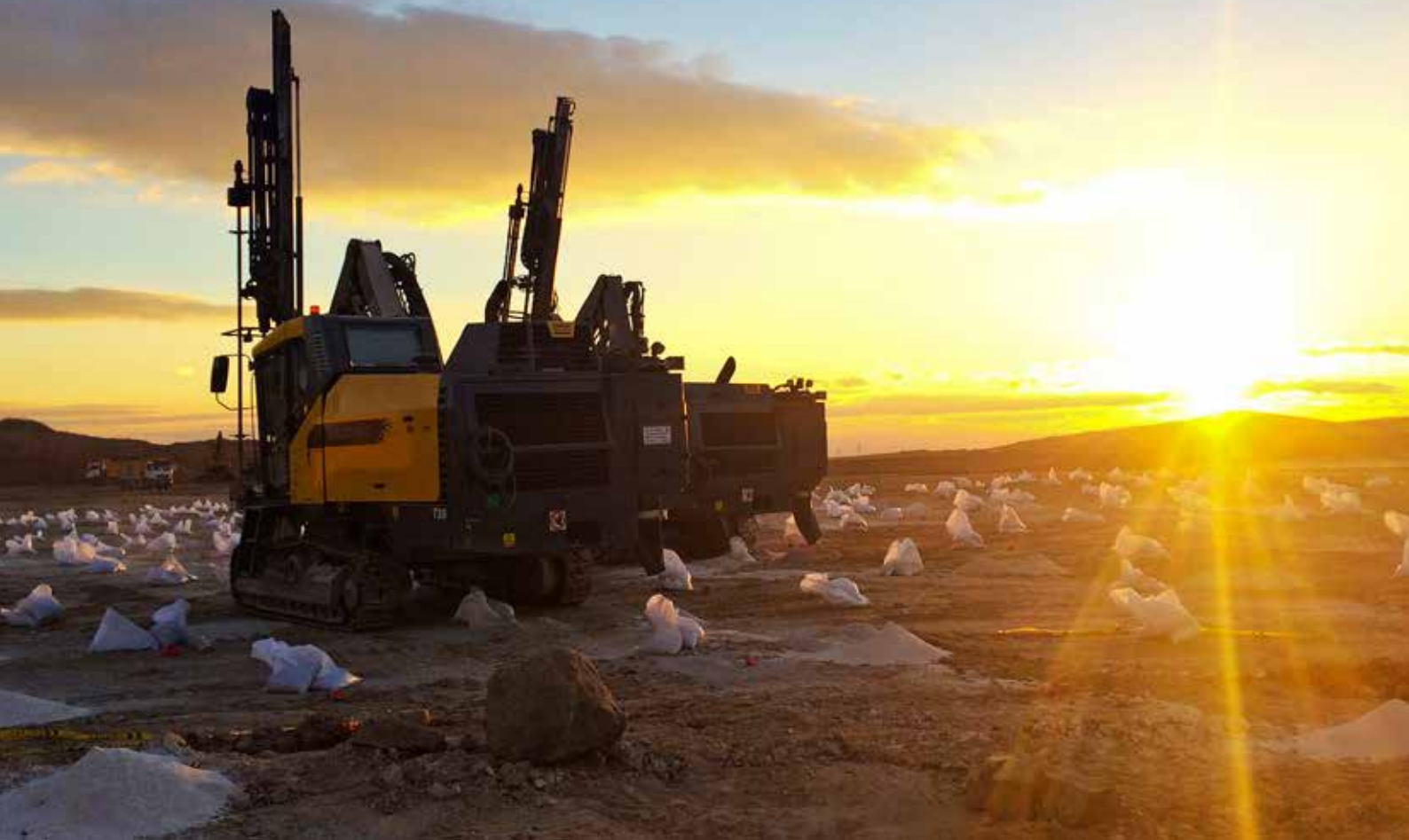
写真のアトラスコブSmartROC T35 とFlexiROC T35トップハンマーリグはPowerbitの試験に使用され、5.5 m深さの発破孔を掘削しました。双方のリグともリトラクデザインで球状のHDチップ(右)を配置した102mm径のPowerbit T51を装備しています。
