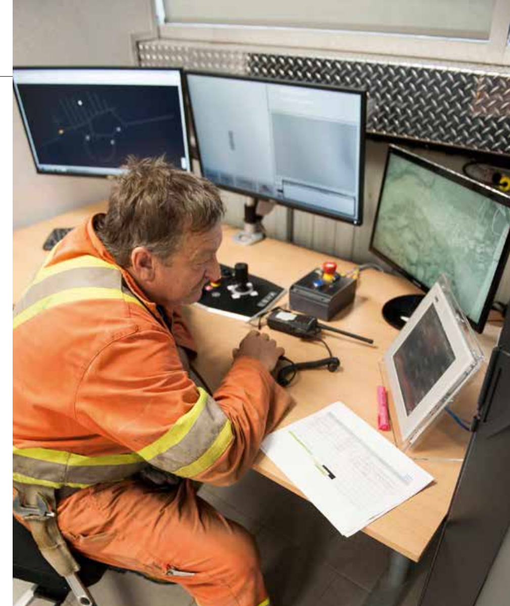
El operario Wayne Locht cambia el Scooptram ST14 a modo control remoto en la zona automatizada ubicada 1,4 km más abajo.
