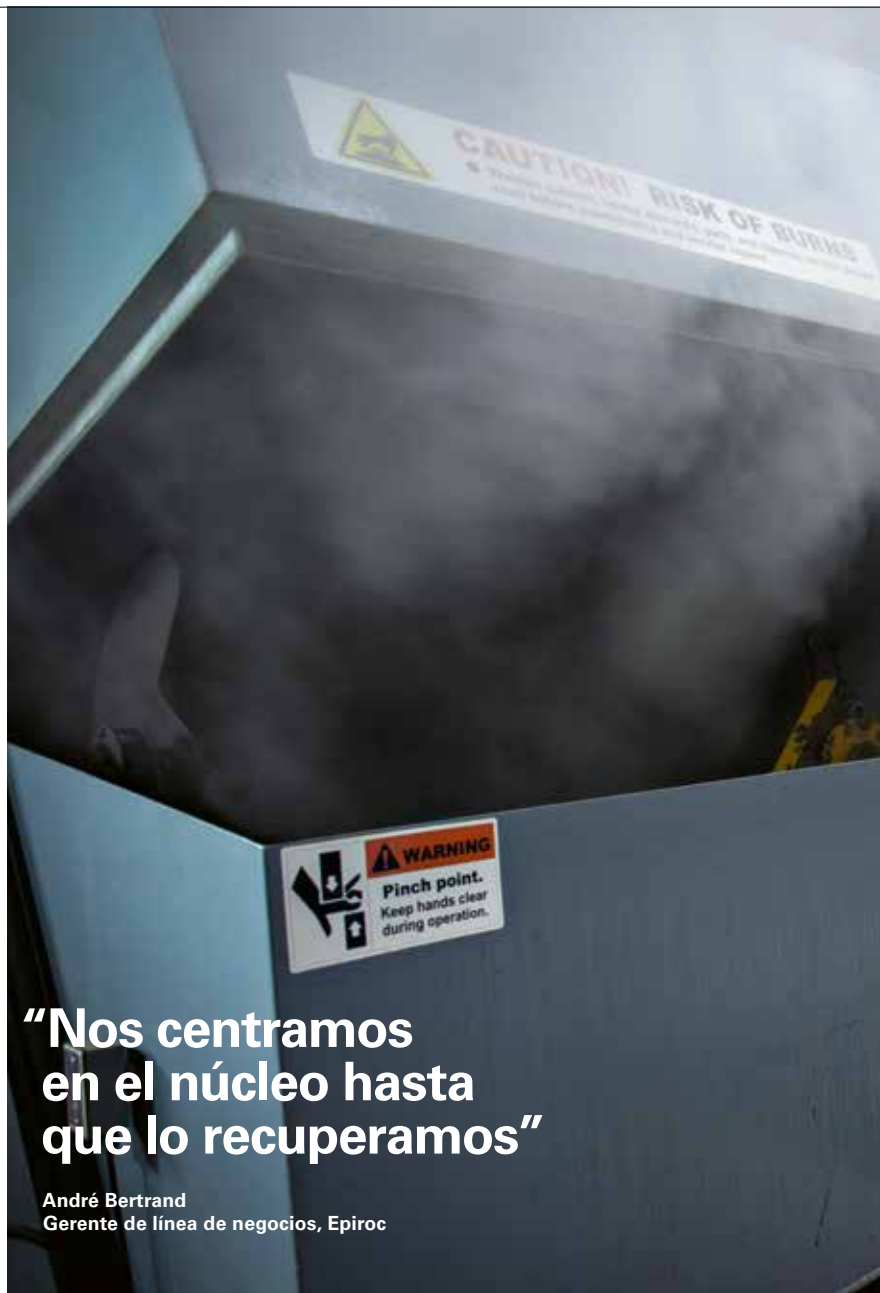
Componente recién lavado en un depósito de lavado de tamaño industrial listo para pasar al siguiente paso del proceso de remanufactura.
