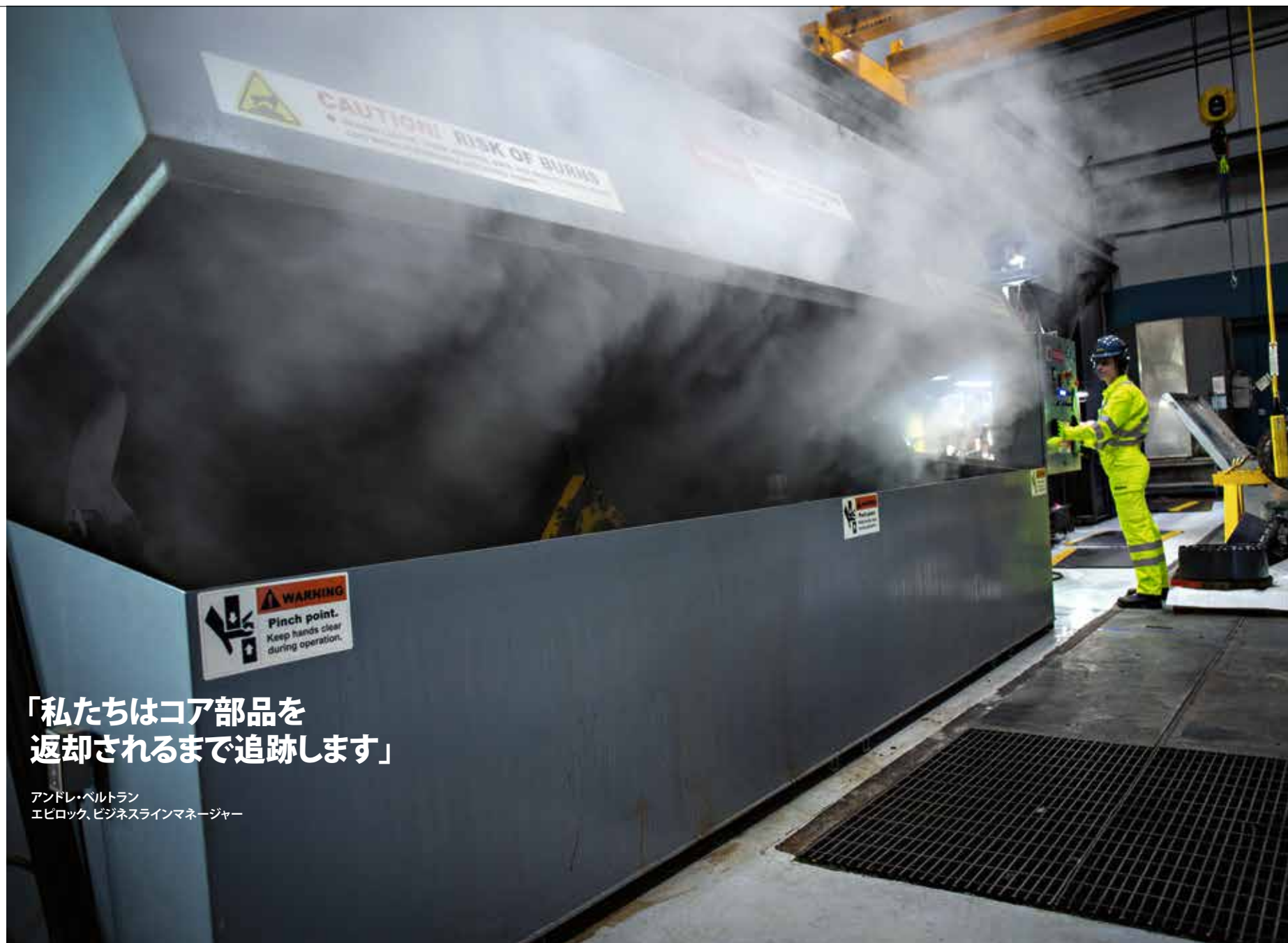
工業用サイズの洗浄タンクで きれいに洗浄されたコンポーネント。 再生工程の次のステップに 進む準備ができました。
