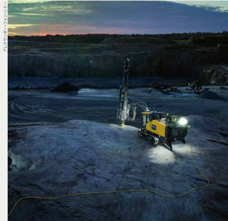
ストックホルムでスキャンスカ社がSmartROC T35 Eのテストを進めています。世界各地の露天掘り鉱山や採石場での掘削を排ガスゼロへと転換する上で、この掘削機が大きな意味を持ちます。
